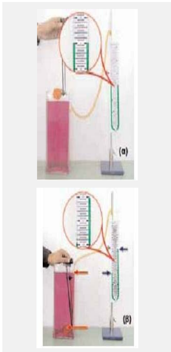
Εικόνα 7: Μέτρηση υδροστατικής πίεσης (α) η μεμβράνη βρίσκεται έξω από το υγρό (β) η μεμβράνη βρίσκεται μέσα στο υγρό
